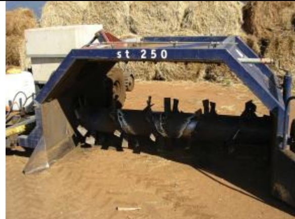
Imported Sandberger ST 250 tractor mounted turner (N. Human)
